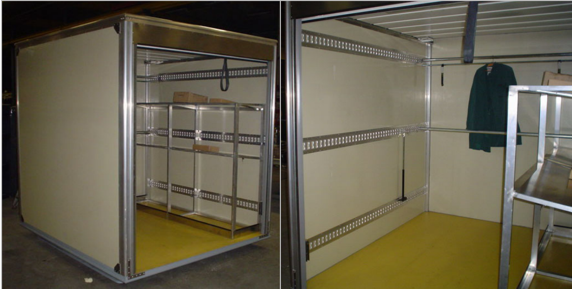
Figuur 35: Universele ladingzekering voor rolcontainers, hangende kleding en pakketjes
