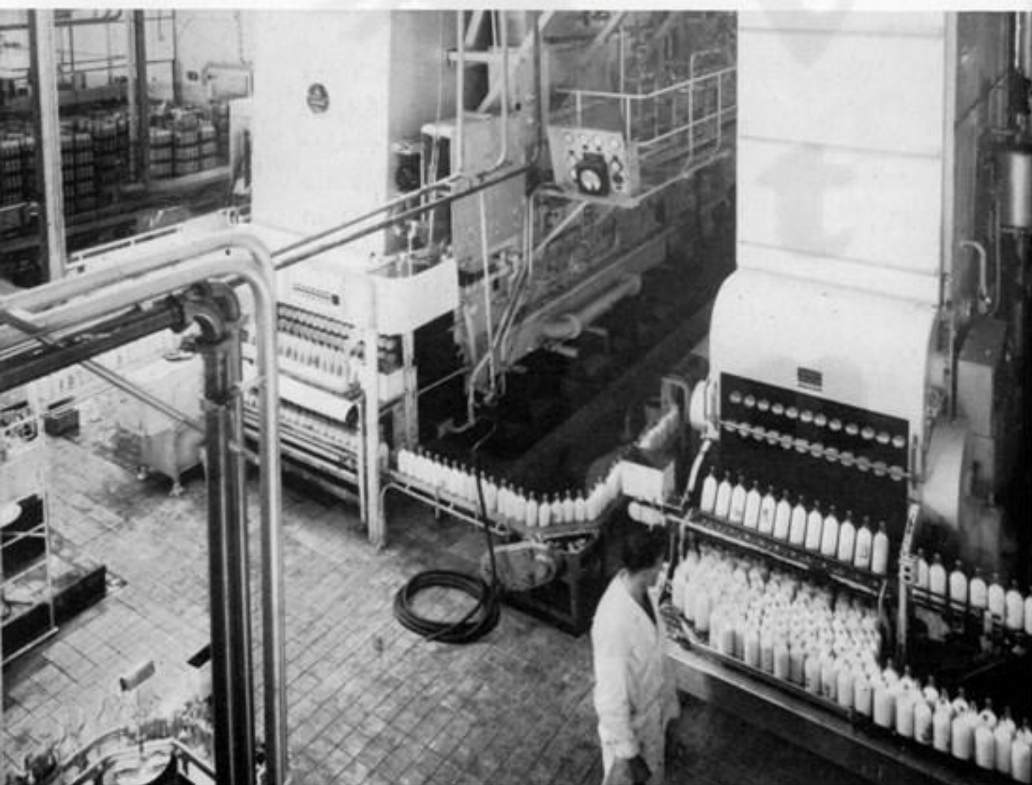
het steriliseren van gevulde flessen in de 14 meter h sterilisatietorens
