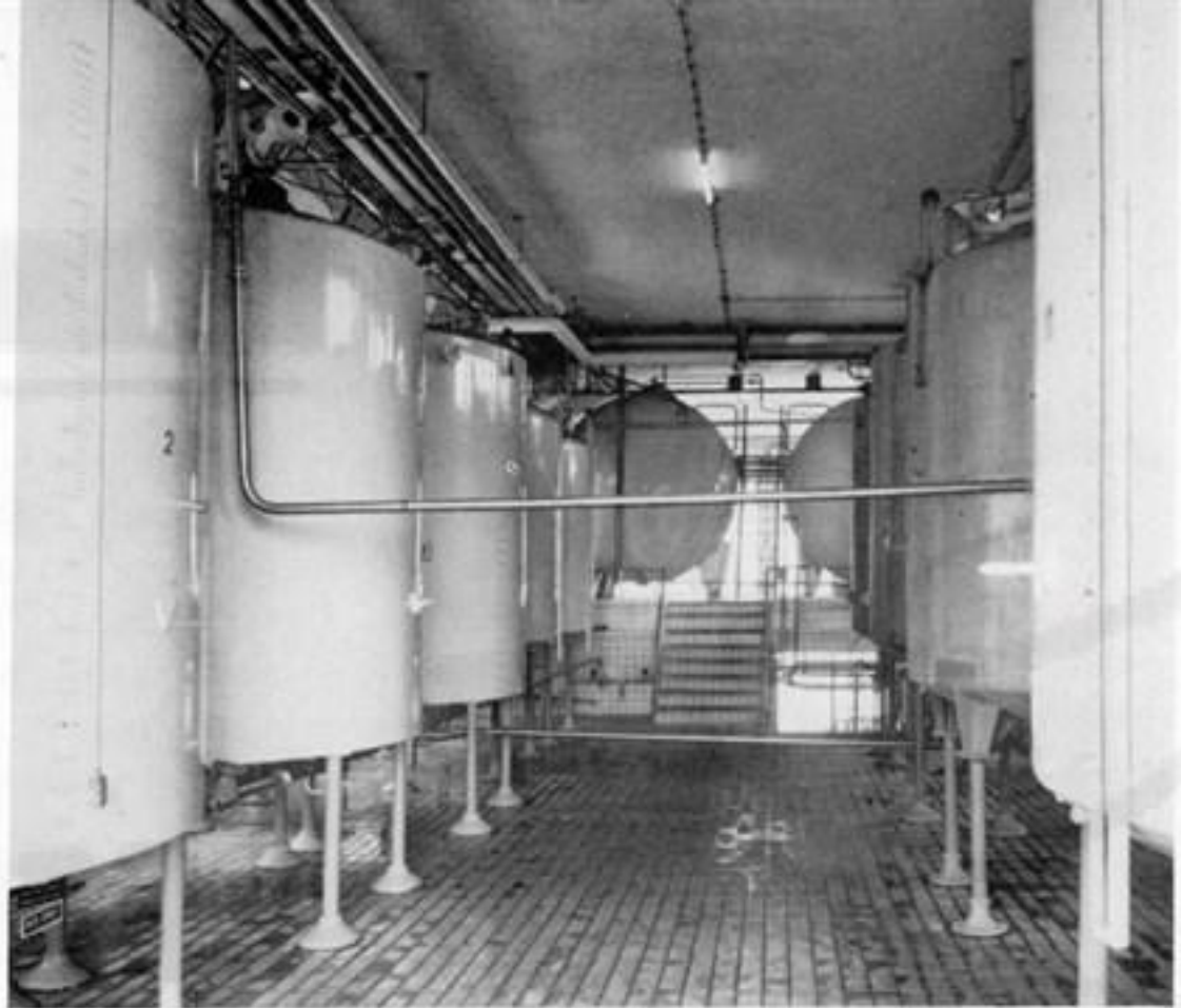
opslagtanks voor het gekoeld bewaren van 180.000 kilogram verse melk
